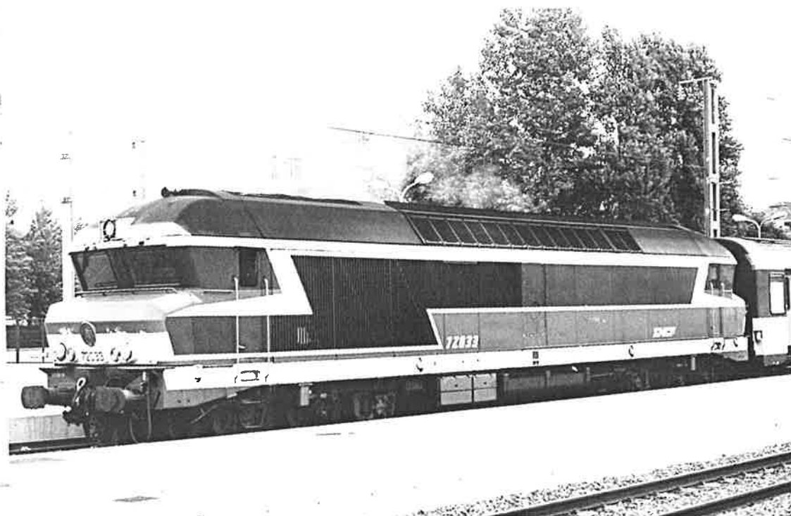
Les CC 72000 sont les plus puissantes locos diesel électriques de la SNCF. Elles assurent des services mixtes : fret lourd à 85 km/h et voyageurs à 160 km/h. Elles furent mises en service entre 1969 et 1974. Puissance : 3000 CV. Attelée à une rame "Corail", la 72033 assure un des services de trains grandes lignes entre Calais Ville et Paris nord via Boulogne, Etaples le Touquet, Abbeville, Amiens. Il faut savoir que la ligne - au demeurant fort pittoresque - au delà de Boulogne vers Amiens n'est pas électrifiée. Outre ces trains classiques, il existe une série de relations directes TGV entre Calais Ville ou Calais Fréthun ( les plus fréquentes ) via la ligne TGV, bien sûr. Calais Ville le 3 juillet 1996 – Photo Dominique Allard.
