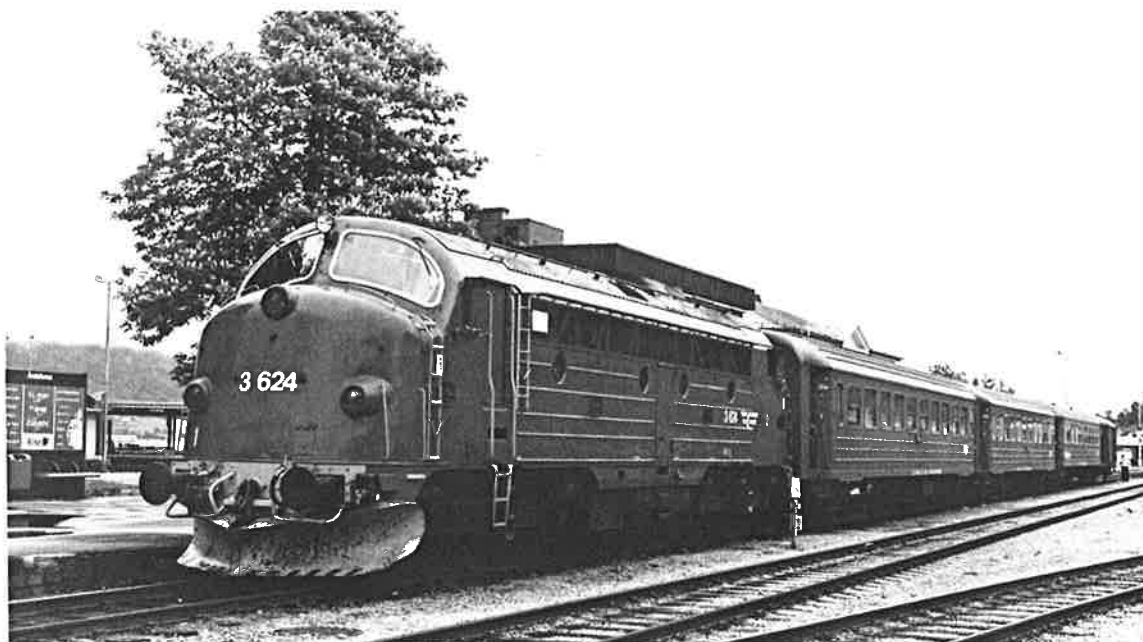
"Gros nez" norvégien de la série Di 3a des NSB – Puissance : 1305 KW Disposition d'essieux : CoCo – Nombre à l'origine : 32 Ces machines assurent entre autres, l'intégralité du trafic sur la très belle ligne à voie unique Andalsnes - Dombas. Elles présentent la particularité d'être virées à chaque terminus, afin de toujours présenter à l'avant le poste de conduite N° 1 ( le seul à avoir été modernisé ) Andalsnes ( Norvège ) 15/06/96 – Photo Dominique Allard
