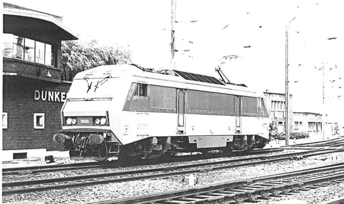
Les BB 26000 dites "SYBIC" ( synchrone bicourant ) sont appelées à remplacer le matériel en fin de course. Elles assurent tant des services voyageurs que des services marchandises. En fait, dans le Nord, je ne les ai vues que remorquant des convois marchandises. Un certain retard dans les livraisons, ainsi que "quelques maladies de jeunesse" ont pour conséquence le maintien en service de machines vieillissantes et plus lentes –Longueur : 17,71 m – Poids : 90 t – Vitesse : 200 km/h. La 26056 à Dunkerque, le 3 juillet 1996 – Photo dominique Allard
